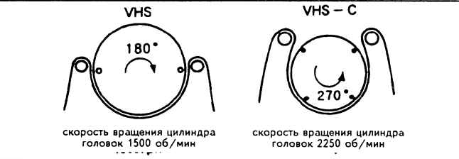
Рис. 8.4. Отличия цилиндра головок камеры VHS-C Movie от цилиндра головок стандартного видеомагнитофона
